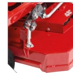
Nouveau système de fixation du plateau de coupe permettant au plateau de mieux suivre le terrain et de limiter fortement les points d'usure.
