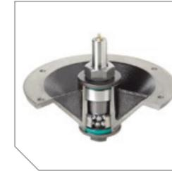
Boitier en fonte de 257mm de diamètre, 6 trous de fixation, arbre de sortie diamètre 30,16mm, roulement conique de 62mm de diamètre avec double rangée de billes, étanchéité par bague à double lèvre, bouclier métal; et possibilité de graissage par le haut du palier.
