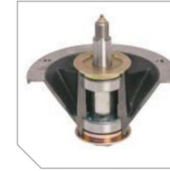
Fusées en fonte pour une durée de vie prolongée, arbre de 25,4 mm doté d'un graisseur accessible par le dessus pour les roulements à billes à graisser doubles, flasque de 201 mm à six boulons qui ajoute de la robustesse et assure une plus grande dispersion de l'énergie vers l'assemblage du plateau.
