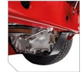
Protection de la transmission très robuste et étroite permettant un bon refroidissement et un accès facile au filtre à huile.
