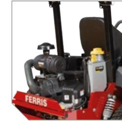
Le moteur à injection électronique BIG BLOCK™ Vanguard™ 993cc avec système Oil Guard délivre un niveau de puissance optimal tout en consommant peu et en assurant des durées et coûts d'entretien réduits.
