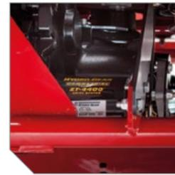
Double transmission Hydro-Gear<sup>®</sup> ZT-4400™ assurant puissance et durabilité.
