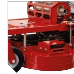
Nouveau système de fixation du plateau de coupe permettant au plateau de mieux suivre le terrain et de limiter fortement les points d'usure et de graissage.
