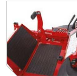
Levage du plateau à commande au pied avec pédale réglable, permet de modifier la hauteur de coupe par paliers de 6 mm, entre 38 et 152 mm.
