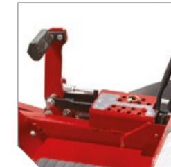
Le levage du plateau à commande au pied avec pédale réglable permet de modifier la hauteur de coupe par paliers de 6 mm, entre 3,8 et 12,7 cm.
