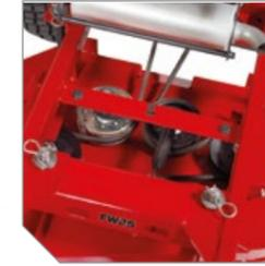
Cinématique du système de courroie étudiée avec le plus grand soin pour assurer une tension de courroies optimum, une fiabilité, et une longue durée de vie.
