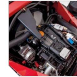
Puissant moteur Yanmar™ 3 cylindres diesel (modèle 3TNM74F-SAFS) conforme à la réglementation définitive des émissions EPA Tier 4 (moteurs répondant à la norme Euro 5).
