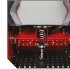
Le système de plateforme suspendue, pour lequel une demande de brevet a été déposée, est réglable selon une vaste diversité de poids et de conditions d'utilisation, ce qui optimise le confort de l'utilisateur et augmente la productivité.
