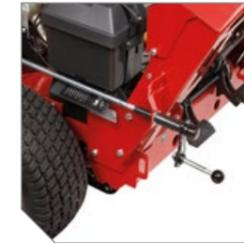
Manivelle de réglage de la hauteur de coupe à utilisation simple, accessible et verrouillable.
