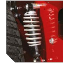
Le système de suspension breveté consiste en des amortisseurs arrière à ressorts réglables (illustrés) et en des amortisseurs avant à ressorts réglables indépendants.
