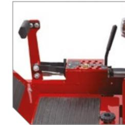
Levage du plateau à commande au pied avec pédale réglable, permet de modifier la hauteur de coupe par paliers de 0,6 cm, entre 3,8 et 12,7 cm (soit entre 1,5" et 5").
