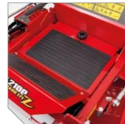
Plate-forme relevable rapidement pour un accès total lors de la maintenance.
