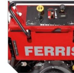
Barre de régulation de la vitesse d'avancement avec un indicateur visuel au tableau de bord.
