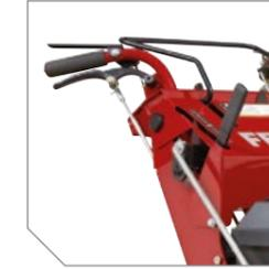
Poignée de frein de stationnement idéalement située à droite du poste de conduite, pour une utilisation souple et efficace.
