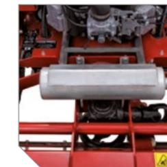
Entrainement par un arbre à cardan résistant et un renvoi d'angle entre le moteur et le broyeur.
