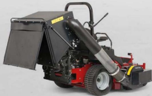
Les tondeuses à rayon de braquage zéro de la série Fleet peuvent être dotées d'un système de ramassage optionnel. Un levier positionné de manière ergonomique augmente la productivité en offrant à l'utilisateur la possibilité d'évacuer l'herbe coupée sans quitter le siège de la tondeuse à siège.
