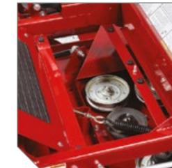
Le retrait rapide de la tôle de plancher offre un accès pratique au-dessus du plateau, pour un nettoyage et un entretien aisés.
