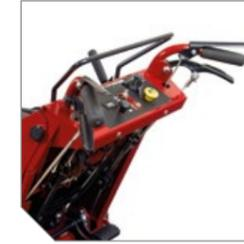
Système de réglage de la vitesse d'avancement et de direction simple; indicateur de vitesse au tableau de bord.
